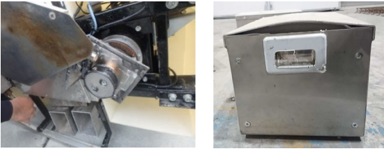
写真-2 鋤回転部下部の破損及びバッテリーボックスの膨張による不具合状況
