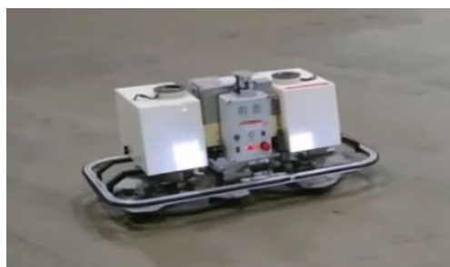
写真-1 コンクリート床仕上げロボット（旧タイプ）
