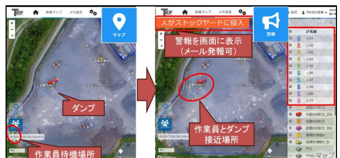
図-12 作業員のエリア内作業警報 Fig.12 Alert for Worker
