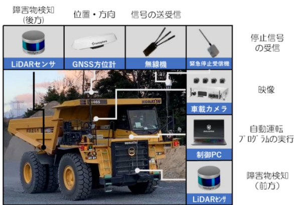
図-1 T-iROBO Rigid Dump の外観及び搭載機器
