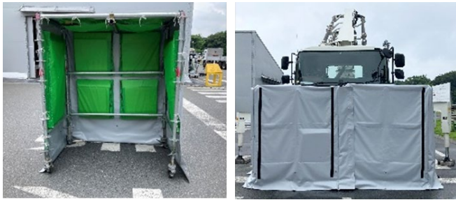
図-11 T-Silent Cover 前方囲いユニット (左：内面 右：外観)
