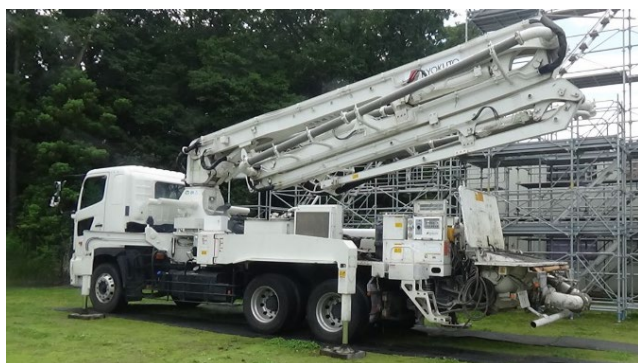
写真-1 コンクリートポンプ車 (ピストン式) Photo.1 Concrete pump truck(piston type)
