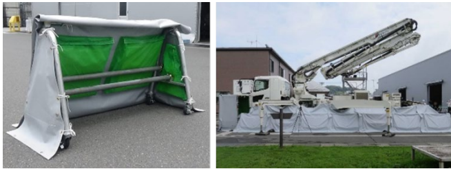
図-12 T-Silent Cover 側方囲いユニット (左：内面 右：外観)
