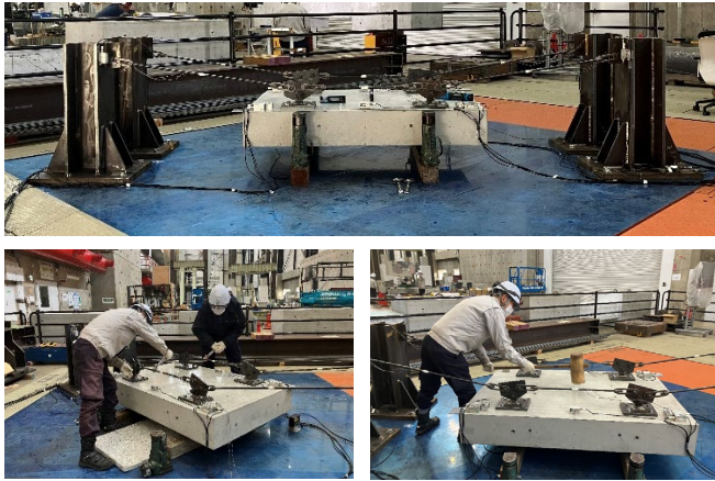
図-7 試験状況 (上：試験体全景，左下：周期調整，右下：打撃状況)
