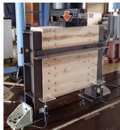
写真-3 試験体のセットアップ Photo.3 Setup of the drift pins test
