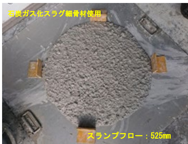
写真-9 コンクリートの広がり状況 (石炭ガス化スラグ細骨材使用) Photo.9 Slump flow spread of Cement Zero type (Coal gasification slag fine aggregate)
