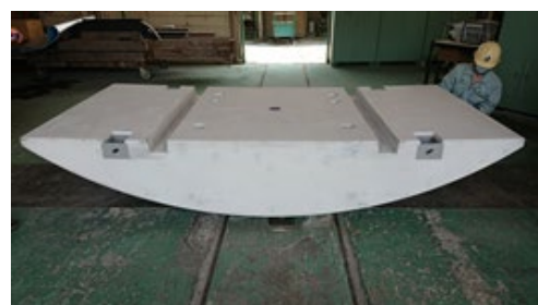
写真-4 インバートの脱型後の外観 Photo.4 Condition after invert demolding
