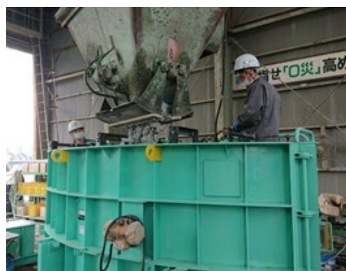
写真-3 セメント・ゼロ型の打込み状況 Photo.3 Cement-zero type casting
