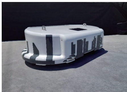
コンクリート床仕上げロボット 改良試作機
