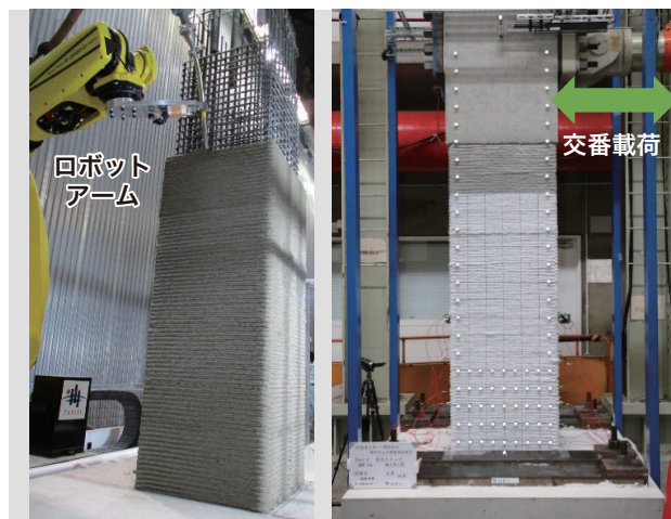
T-3DPによる鉄筋回避プリントと試験状況
