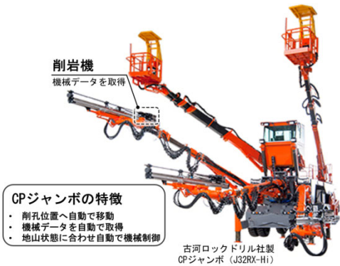
図-1 CP ジャンボの特徴 Fig.1 The characteristics of CP-assisted jumbo machine
