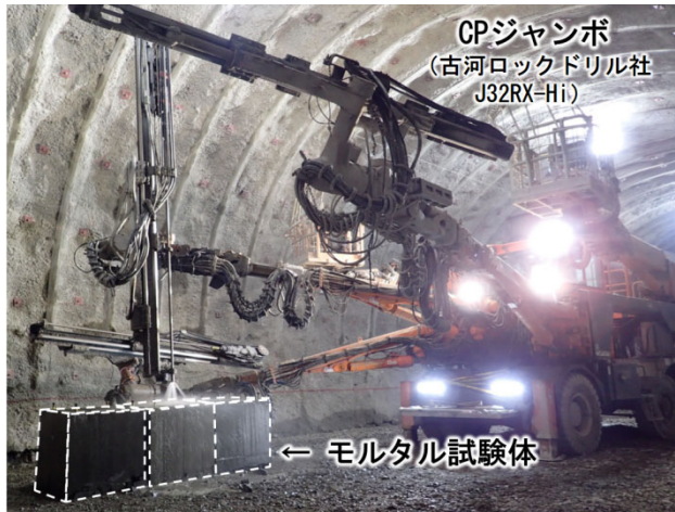
写真-1 予備試験でのモルタル試験体の削孔状況 Photo 1 Mortar drilling situation in preliminary test
