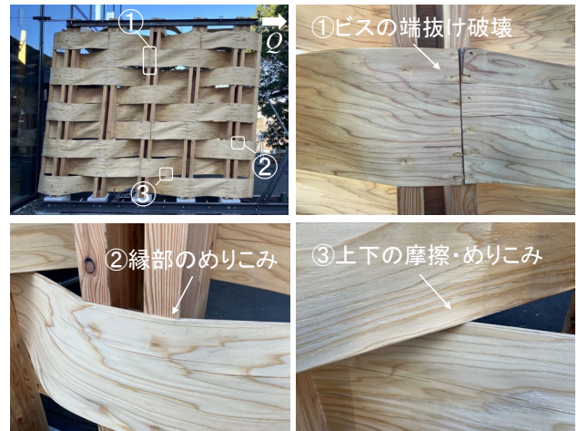
写真-5 破壊性状一覧（西面） Photo.5 Fracture mode (west side)
