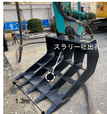
写真-2 専用バケット Photo.2 Specialized bucket
