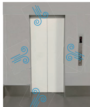
低層階において自動扉およびエレベータ扉へ 流入する気流のイメージ
