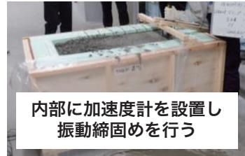
内部に加速度計を設置し
