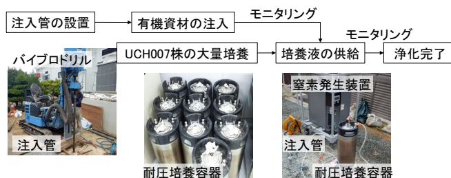
図-11 Dehalococcoides 属細菌を汚染帯水層に導入する浄化手順
