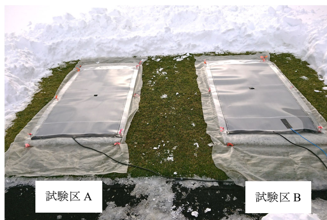
写真-1 試験区の設置状況 (2021年12月21日) Photo.1 Test plots of the fabric heater
