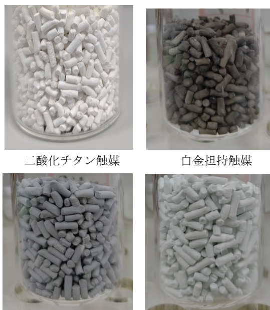
二酸化チタン触媒 白金担持触媒 パラジウム担持触媒 銅担持触媒 写真-1 実験用触媒 (φ1.3mm×5.0mm) Photo.1 Catalysts used in the experiment
