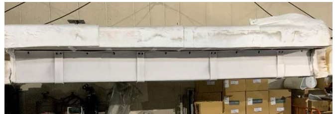
写真-10 加熱後の試験体(試験体 No.2) Photo.10 Specimen after heating(Specimen#2)
