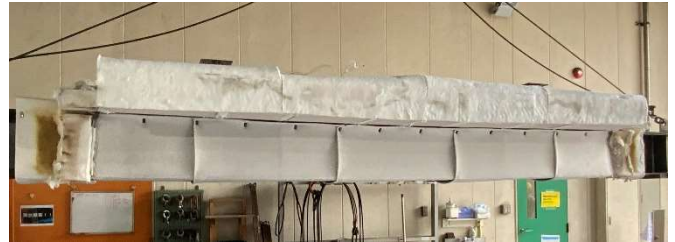
写真-8 加熱後の試験体(試験体 No.1) Photo.8 Specimen after heating(Specimen#1)
