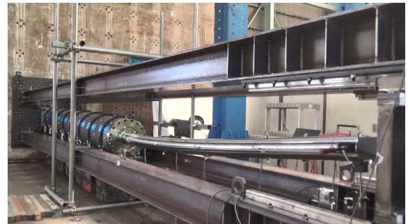
写真-1 錘+3G相当 700kN加力時変形
