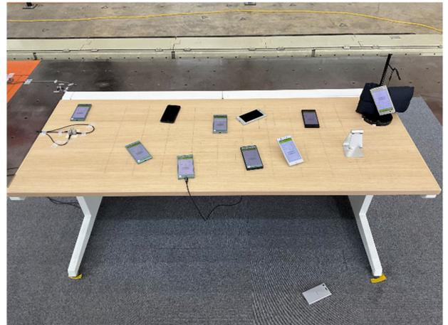
写真-2 2011/3/11 日立波(800 cm/s<sup>2</sup>)の加振後の様子
