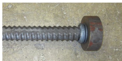
a)D51 SD490 の Head-bar 定着具
