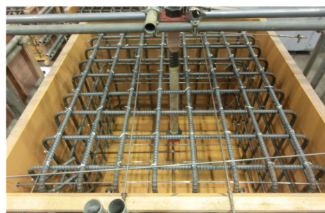
b)試験体配筋状況
