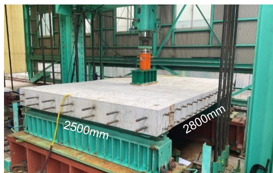
写真-3 載荷試験状況 Photo.3 Loading test conditions
