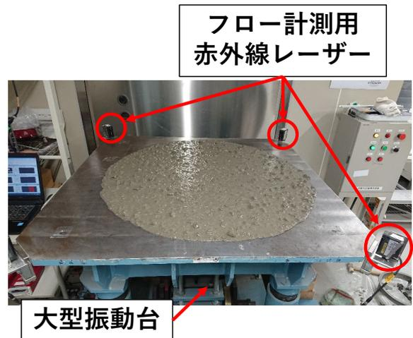
図-3  $E_f$  (流動性) 評価試験
