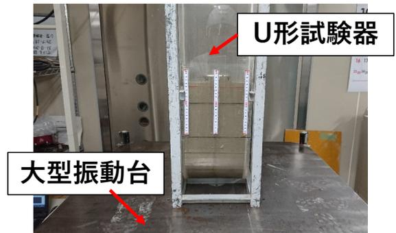
図-4  $E_u$  (間隙通過性) 評価試験
