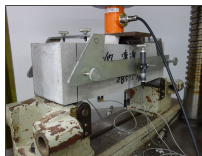
写真-2 切欠きはり 3 点曲げ載荷試験
