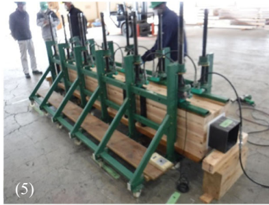
(5) 4枚目の集成材による蓋をして 二次接着・圧縮(2回目)
