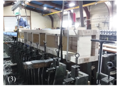
(3) 3枚の集成材を二次接着・圧縮して (1回目)、溝形の函体を製作
