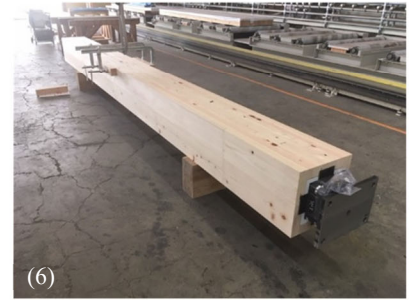
(6) 表面仕上げ・塗装をして完成。 養生をして現場へ搬入する
