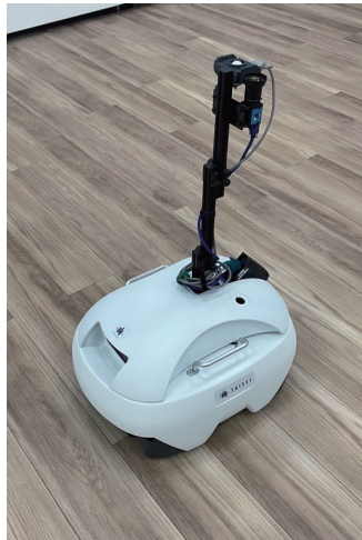
照度測定状況 (一般照明測定走行時)
