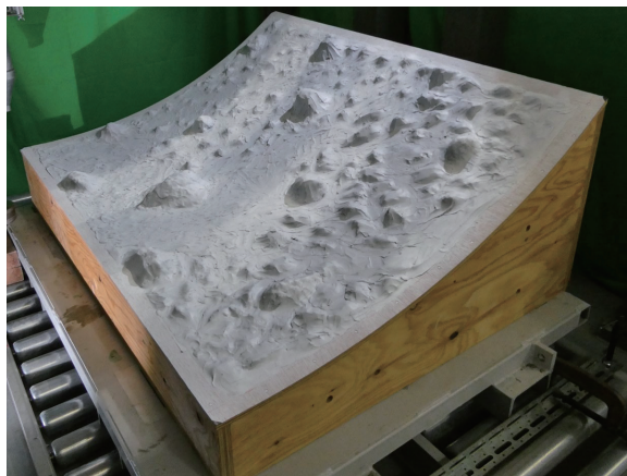
勾配と凹凸を有する不陸な模擬地盤面
