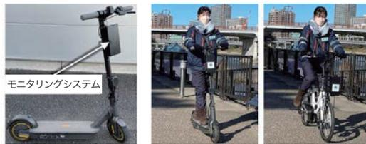
モニタリングシステムと計測用電動モビリティ
