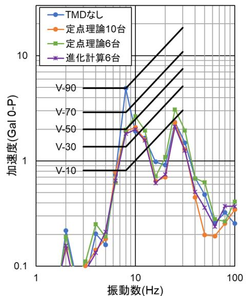
図-9 X 方向一人歩行時の点 X32Y22 における振動測定結果
