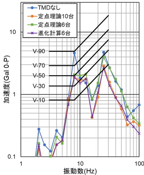
図-11 Y方向一人歩行時の点 X32Y22 における振動測定結果
