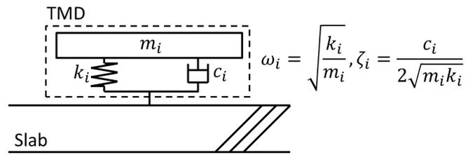
図-1 TMDの力学モデル
