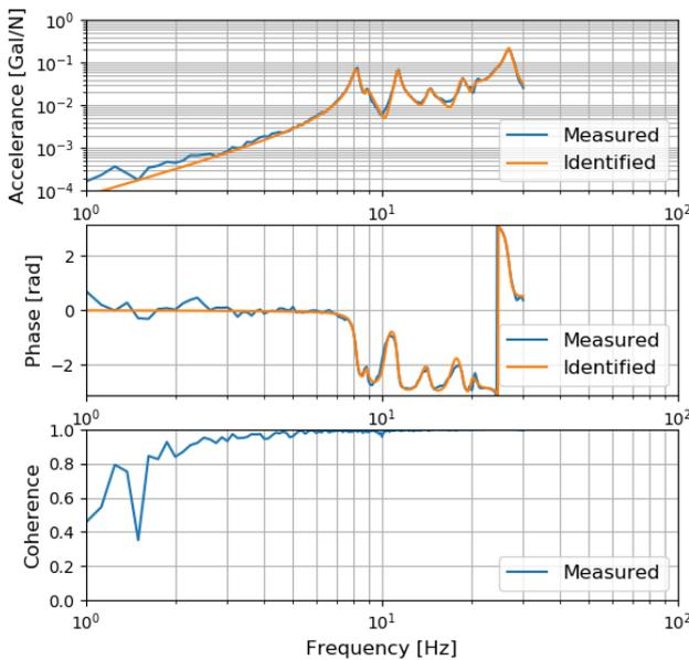
図-5 点 X32Y22 におけるアクセランスの測定結果および同定結果
