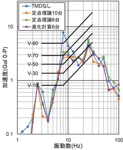
図-10 X方向一人小走り時の点 X32Y22 における振動測定結果
