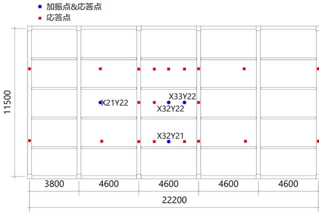
図-4 測定対象建物の床伏図と加振点および応答点
