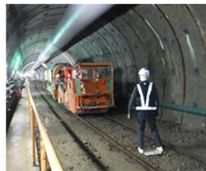
写真-13 バッテリーロコ適応の実証試験状況① (左：前進，右：後進)
