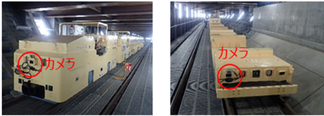
写真-16 バッテリーロコへの適応事例② (左：前方，右：後方) Photo.16 Application example to battery loco② (L:front, R:rear)
