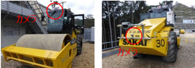
写真-8 振動ローラーへの適応事例 (左：前方，右：後方)
