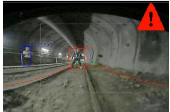
写真-14 バッテリーロコ適応の検知状況① 注2)
