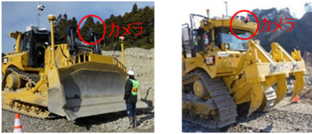
写真-9 ブルドーザへの適応事例(左：前方，右：後方) Photo.9 Application example to bulldozer(L:front, R:rear)
