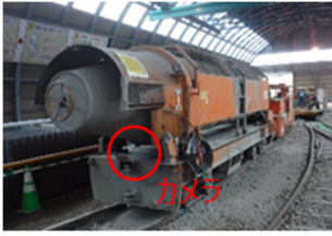
写真-12 バッテリーロコへの適応事例① (左：前方，右：後方)
