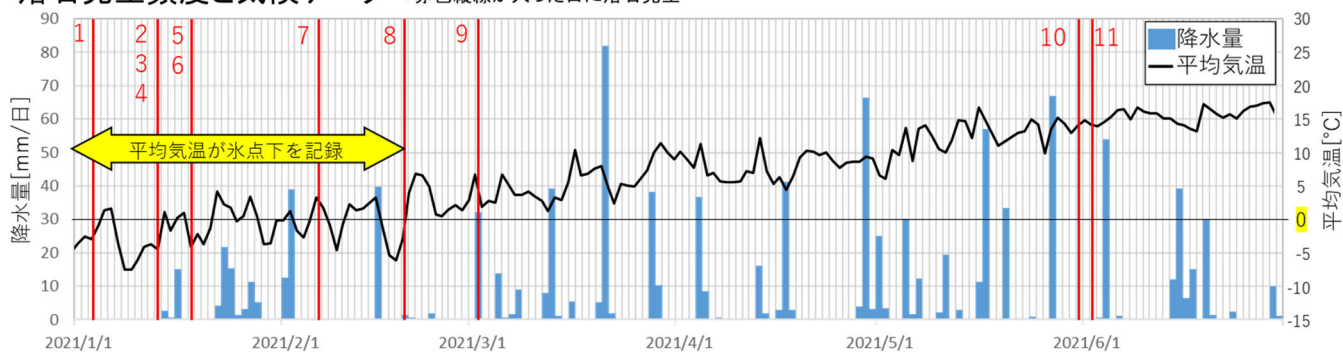
図-3 落石の発生日と降水量・気温の記録 (赤色実線が落石発生日, 赤数字は発生順 No.を示す)
