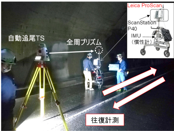
図-7 MMS (Leica ProScan)の実施状況
