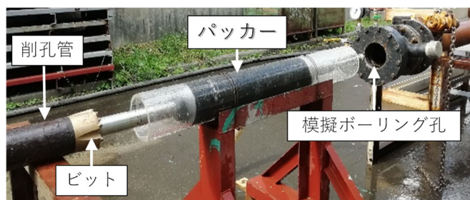
図-8 パッカー拡張状況 Fig.8 Inflated of packer
