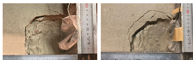
(a) Case 2 : 拡底部無し (b) Case 5 : 拡底部有り 図-8 地表面崩壊形状 (3次元, 奥行き90mm)
