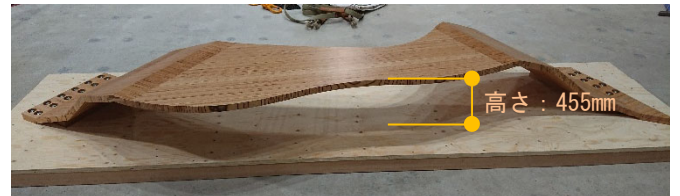
写真-5 ベンチモックアップ試験体(全景) Photo.5 Bench mockup for loading test (overall view)
