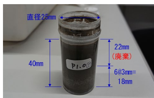
写真-1 供試体 (切断前)
