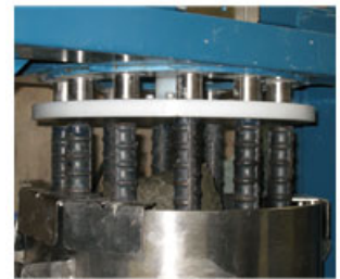
(d) 試料高さの測定
