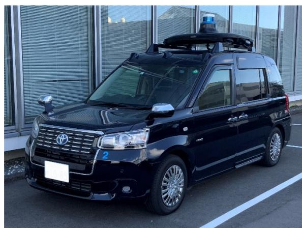
写真-3 使用した自動運転車両
