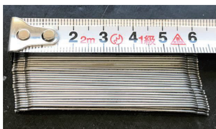
本研究で用いた高性能鋼繊維 (長さ60mm, 直径0.75mm)
