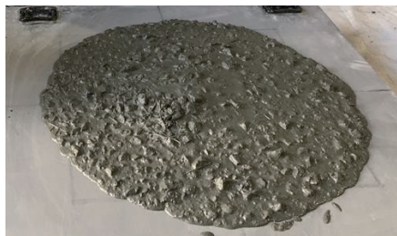
本研究で用いた鋼繊維補強コンクリート (SFRC)
