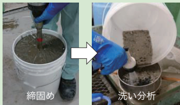
締固め後の粗骨材残存率を測定
