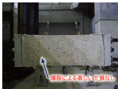
実物大セグメント耐火実験（加熱後）
