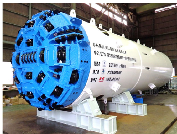
高水圧対応土砂シール搭載型シールド機（最大2MPa対応；世界初）
