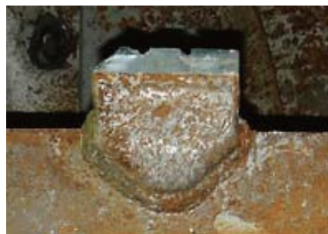
砂礫層掘進により超硬チップが損傷した事例
