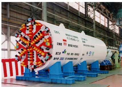
ロングストロークジャッキを 装備したシールド機
