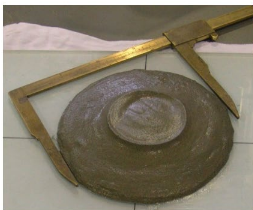
流動化処理土のフロー試験状況
