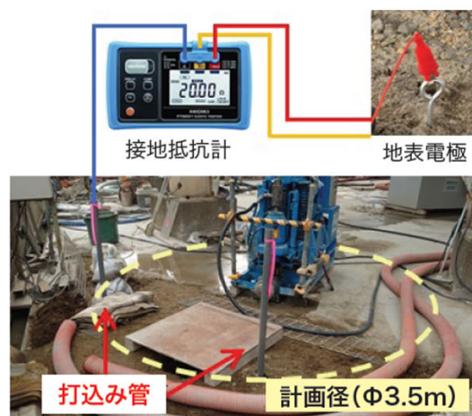
高圧噴射攪拌工法における測定事例
