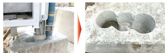
連孔スロット穿孔状況（模擬岩塊）
