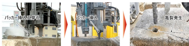
穿孔割岩状況（模擬岩盤試験）
