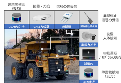
T-iROBO Rigid Dumpの搭載機器
