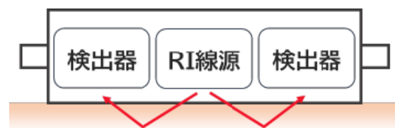
計器内部：RI線源と検出器を搭載
