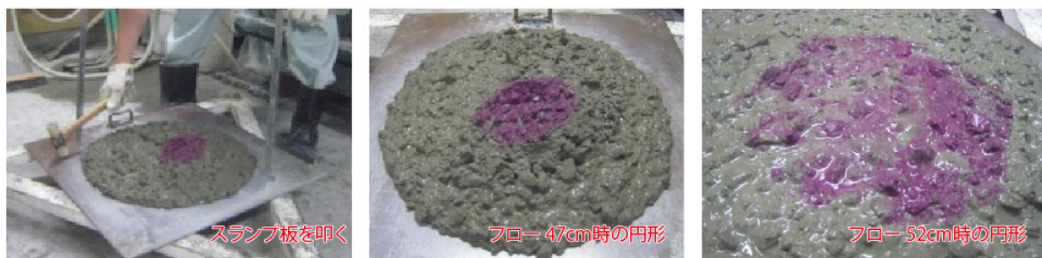
コンクリートの分離抵抗性を「簡易・即時」に評価
