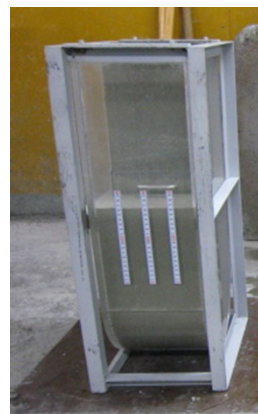
U形装置を用いた充填試験 [JSCE-F511] コンクリートの充填性を評価します。
