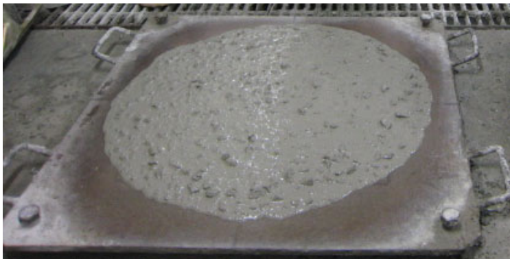
スランブフロー試験 [JIS A 1150] コンクリートの流動性、材料分離抵抗性を評価します。
